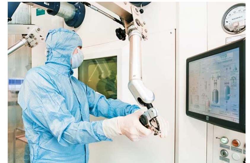
Производство генераторов Технечия-99 в НИФХИ им. Л. Я. Карпова, Обнинск. Фото – Страна Росатом
