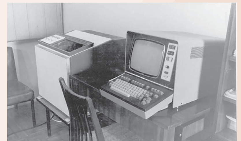
Диалог пользователя с автоматизированной информационно-поисковой системой осуществлялся с помощью устройства «Видеотон-340»
