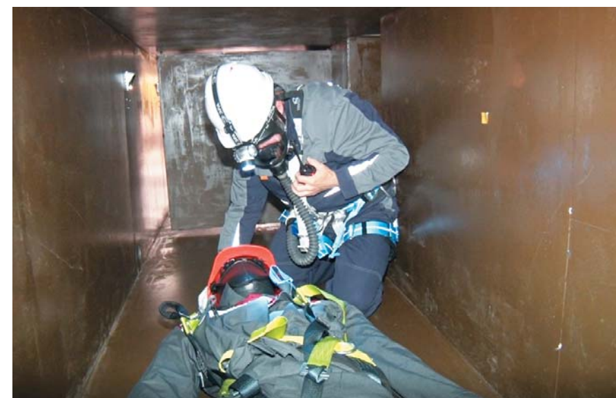
Тренировочный горизонтальный модуль позволяет отрабатывать навыки по спасению человека в узких проходах с использованием средств защиты.
